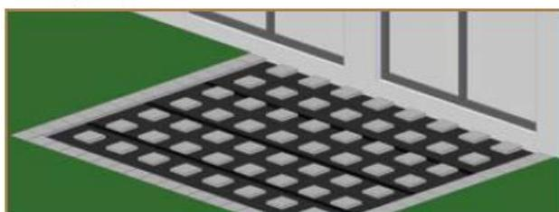
6. Se la sottostruttura è messa in posa con le travi portanti sulla faccia dell'altezza, in senso longitudinale la distanza delle lastre in cemento dovrebbe essere di circa 70 cm (centro - centro, max. 50cm nel caso le travi portanti poggino sulla faccia della larghezza).
